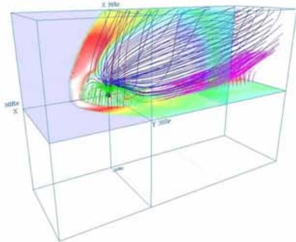
図 9: 地球磁気圏の磁力線の 3 次元構造 (gm480b.ps)
