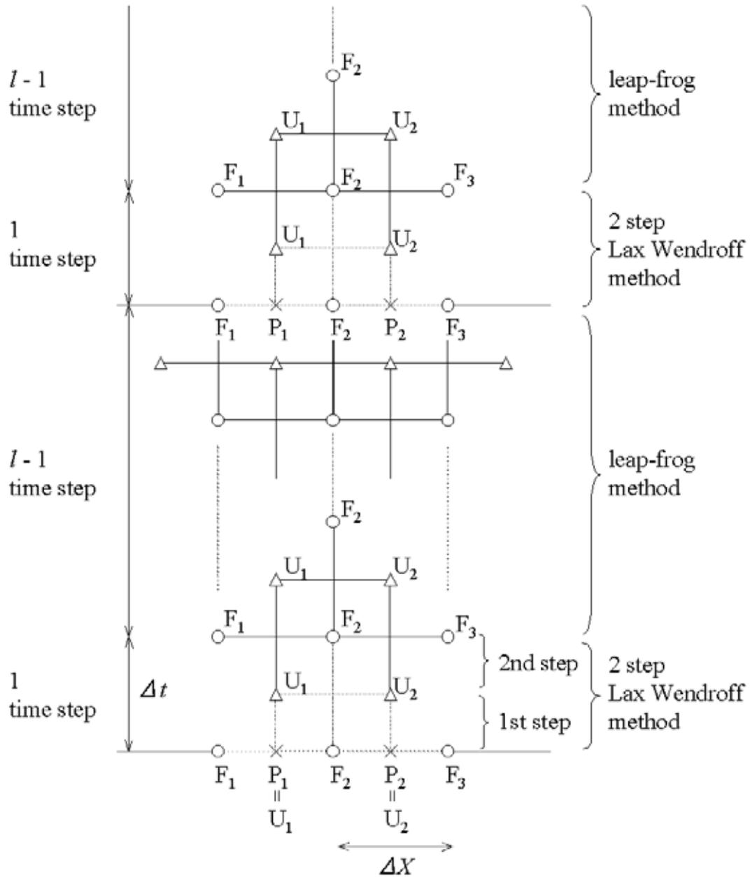
図 2: Modified Leap-Frog 法の計算スキーム
